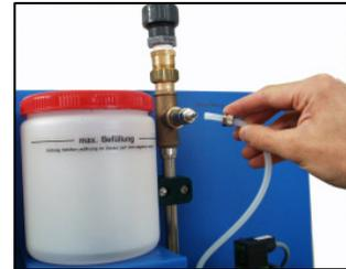
Beim ersten Auffüllen des Duftstoff-Behälters gelang automatisch Luft in den Pumpenkopf. Um eine sichere Funktion der Pumpe zu gewährleisten, muss diese entlüftet werden. Dazu muss der Pumpenschlauch vom Dosierventil abgezogen werden (s. Bild). Bei jedem weiteren Nachfüllen von Duftstoff muss die Pumpe nicht mehr entlüftet werden!
